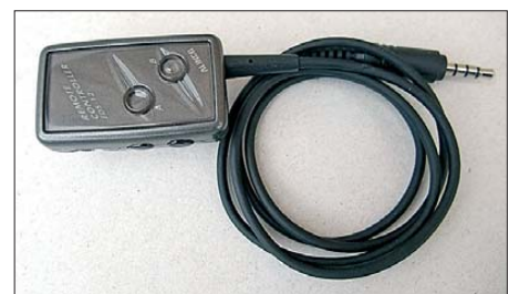
Bild 7: Die optionale Fernbedienung EDS-12 erlaubt den unauffälligen Betrieb des Empfängers.
