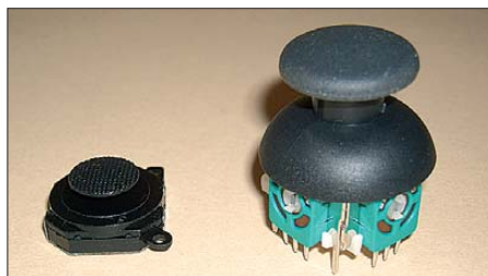
Bild 3: Diese Joysticks liefern durch die Potenziometer Analogwerte.
