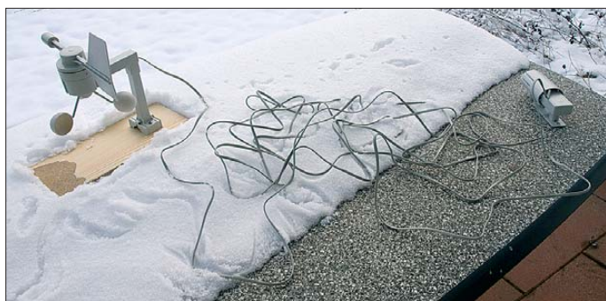
Bild 14: Wind- und Temperatursensor der WS 3650 verdrahtet
