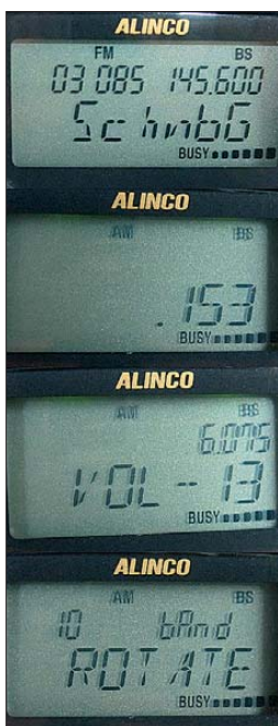
Bild 6: Beispiele für Displayanzeigen: Während im Speicherbetrieb die Anzeige mit Speicherbank, Speichernummer, Frequenz und Namen gut gefüllt ist, wirkt die Anzeige einer LW-Frequenz im VFO fast schon kahl. Die eingestellte Lautstärke wird direkt angezeigt, die Auswahl im Menü ROTATE entscheidet darüber, ob die Bereichsgrenzen übersprungen werden.
