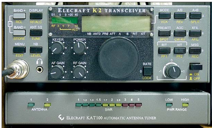
Bild 1: Brachte vielen QRP-Enthusiasten das Erfolgserlebnis eines selbst gebauten Transceivers: der Elecraft K2
