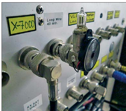
Bild 1: Koaxialstecker mit Glimmlampe und Piezo- schallwandler (ohne eingebaute Elektronik)
