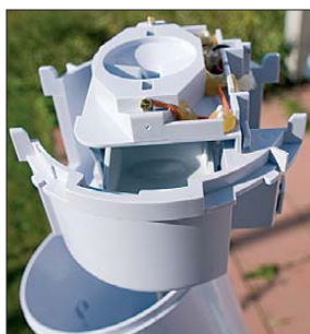
Bild 6: Blick in den Regensensor KS 300
