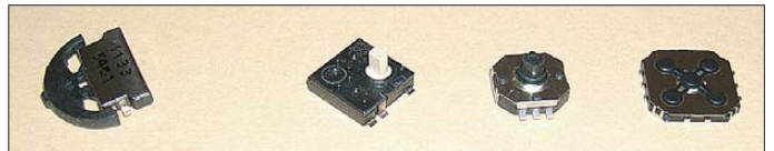
Bild 2: Ein- und mehrdimensionale Miniatur-Navigationsschalter besitzen intern nur Tasten.
