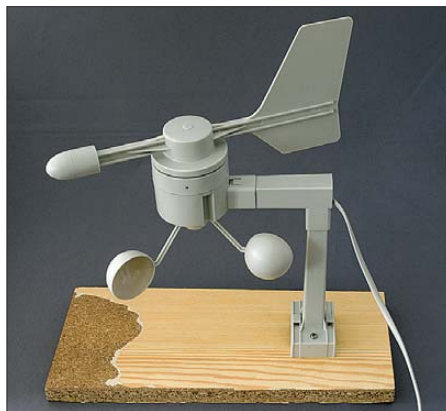
Bild 12: Der Windsensor der WS 3650 – zum Test auf ein Stück Holz geschraubt
