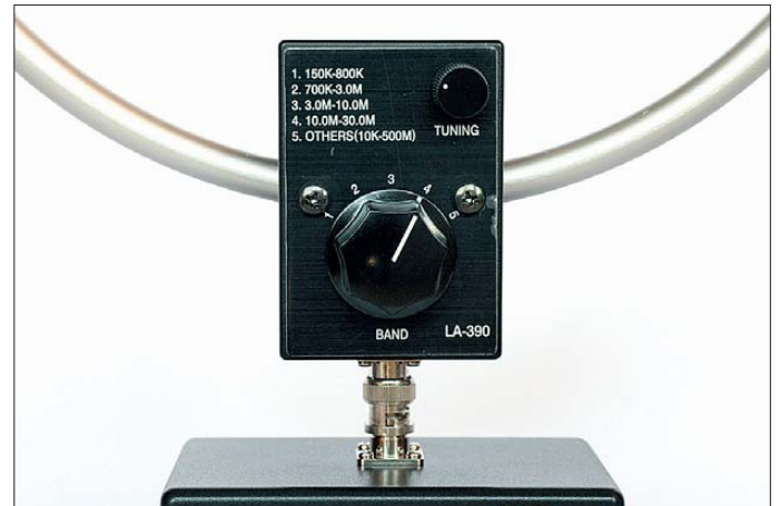
Bild 2: Am Fußpunkt des Rahmens wird die Antenne manuell auf die Empfangsfrequenz abgestimmt.
