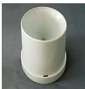
Bild 16: Kein Spucknapf, sondern der Regensensor der WS 3650
