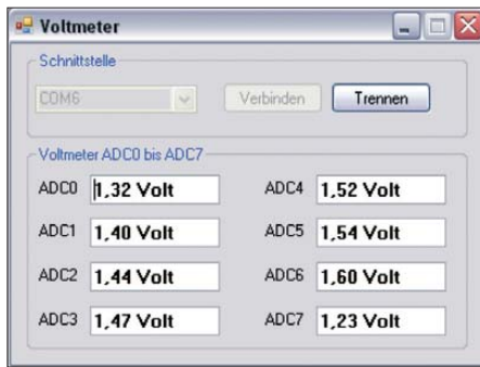
Bild 7: Beim Achtkanal-Voltmeter misst der Controller simultan acht Spannungen und überträgt die Werte zum Windows-PC. Fotos, Screenshots: DL1DMW (6), Franzis (1)
