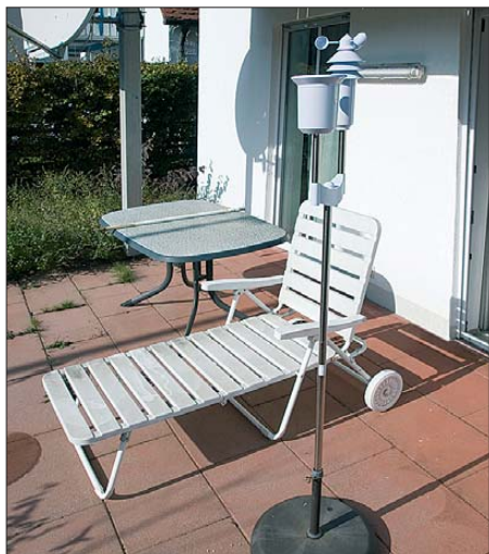
Bild 7: Aufstellung des Wettersensors KS 300 in einem Sonnenschirmständer
