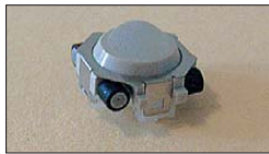
Bild 4: Ansicht eines Minitrackballs, wie er auch in Mobiltelefonen Verwendung findet
