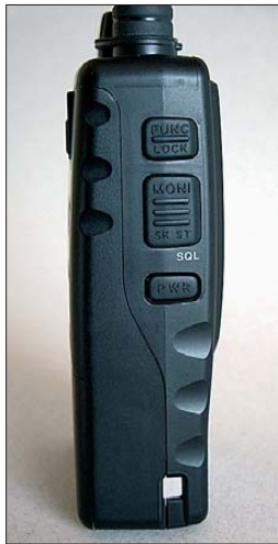
Bild 5: Die versenkte Einschalttaste vermeidet versehentliches Ein- oder Ausschalten.
