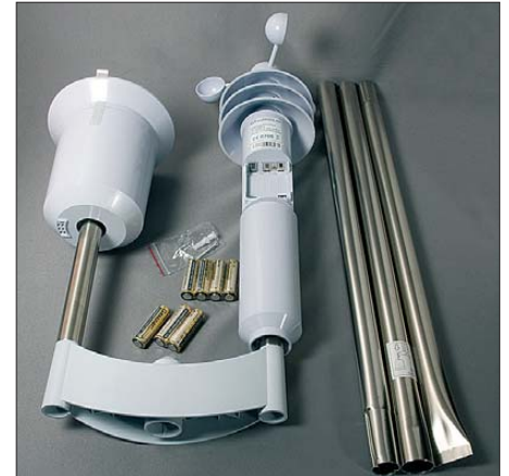
Bild 4: Zur WS 300 gehörender Außensensor (Regen, Wind, Temperatur, Feuchte) KS 300 und Montagerohre/Erdspeiß
