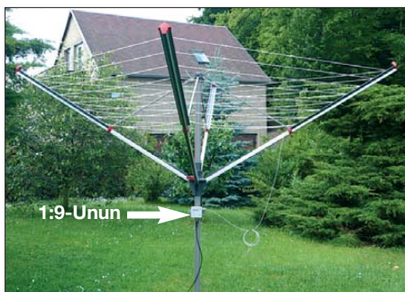
Bild 1: Bei der Wäschespinnenantenne ist nur die oberste „Leine“ als Strahler ausgeführt, der Rest ist Tarnung. Fotos: DM2CM
