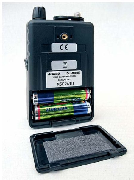
Bild 2: Die Stromversorgung erfolgt mit zwei Mignonzellen. Akkumulatoren sind im Gerät ladbar.
