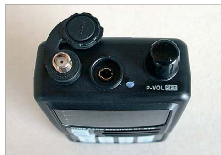
Bild 4: In die Kopfhörerbuchse kann wahlweise ein zwei- oder dreipoliger Klinkenstecker für Ohrhörer (nur ein Kanal) oder ein vierpoliger für zusätzliche Fernsteuerung eingesteckt werden.
