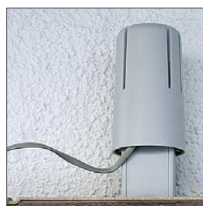
Bild 15: Montierter Thermo-Hygro-Sensor der WS 3650
