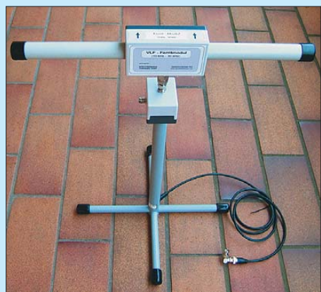
Bild 10: Power-Ferritmodul von BAZ [2] auf einem Ständer, siehe auch [19] Fotos: DL4EAU (1), DG9WF (1)
