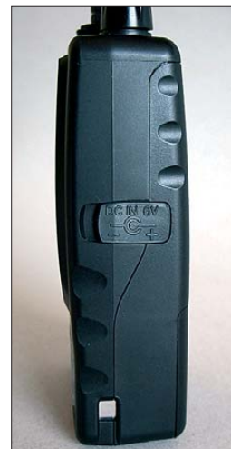
Bild 3: Der Empfänger kann auch mit 6 V extern versorgt werden.
