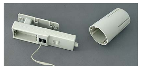
Bild 13: Der Temperatursensor der WS 3650 – zerlegt, mit geöffnetem Batteriefach
